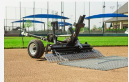
Il faut surtout éviter d'utiliser des véhicules trop lourds ou non destinés à l'entretien des terrains sportifs. Un véhicule trop lourd compactera le sol exagérément et pourrait endommager le système de drainage du terrain.
