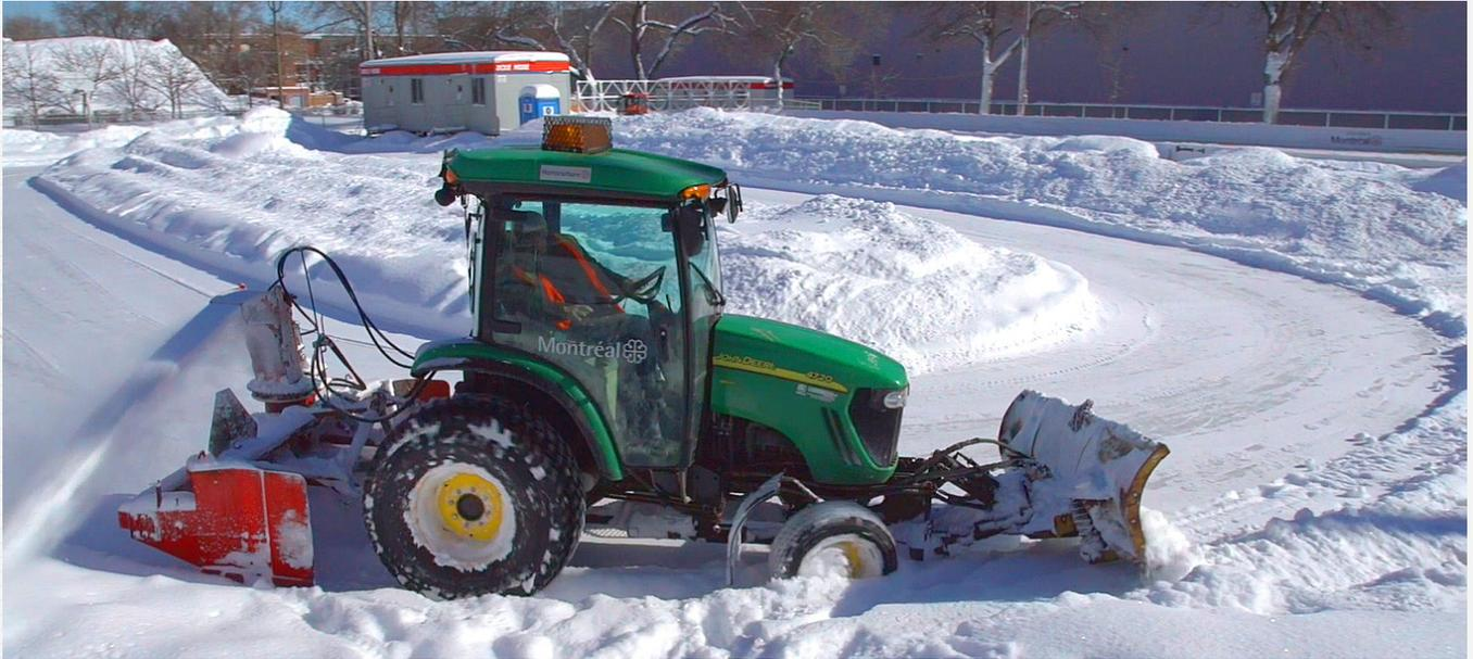
Généralement, l'équipement autoporté affecté aux opérations de déneigement s'appuie sur un assortiment de souffleuses et de grattes. L'envergure des installations justifie le format et la puissance de ces engins. La combinaison d'une gratte et d'une souffleuse constitue l'attirail par excellence des opérations de déneigement.
